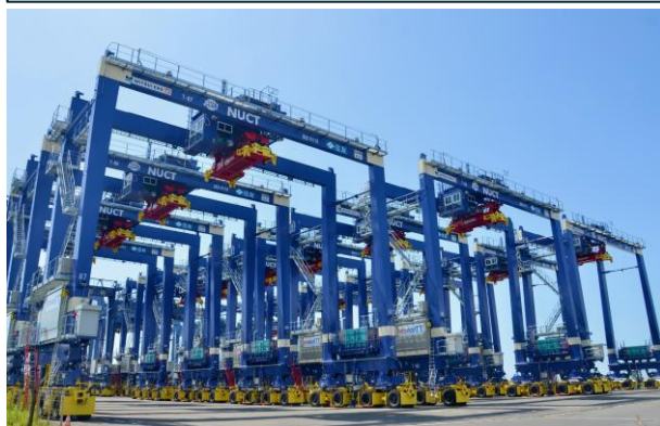
遠隔操作・電動RTG
